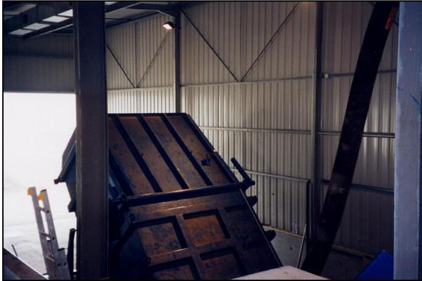
Caisson de réception des boues de station d'épuration
