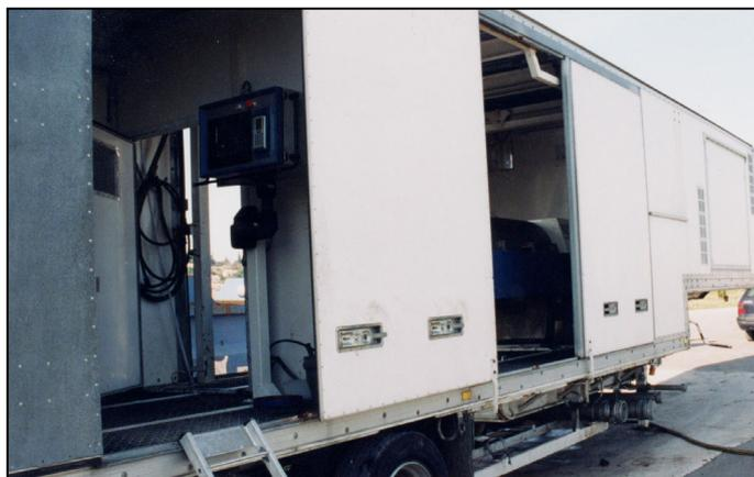
Centrifugeuse mobile utilisée pour déshydrater les boues avant mélange et broyage avec un support carboné ( type écorces de bois)
