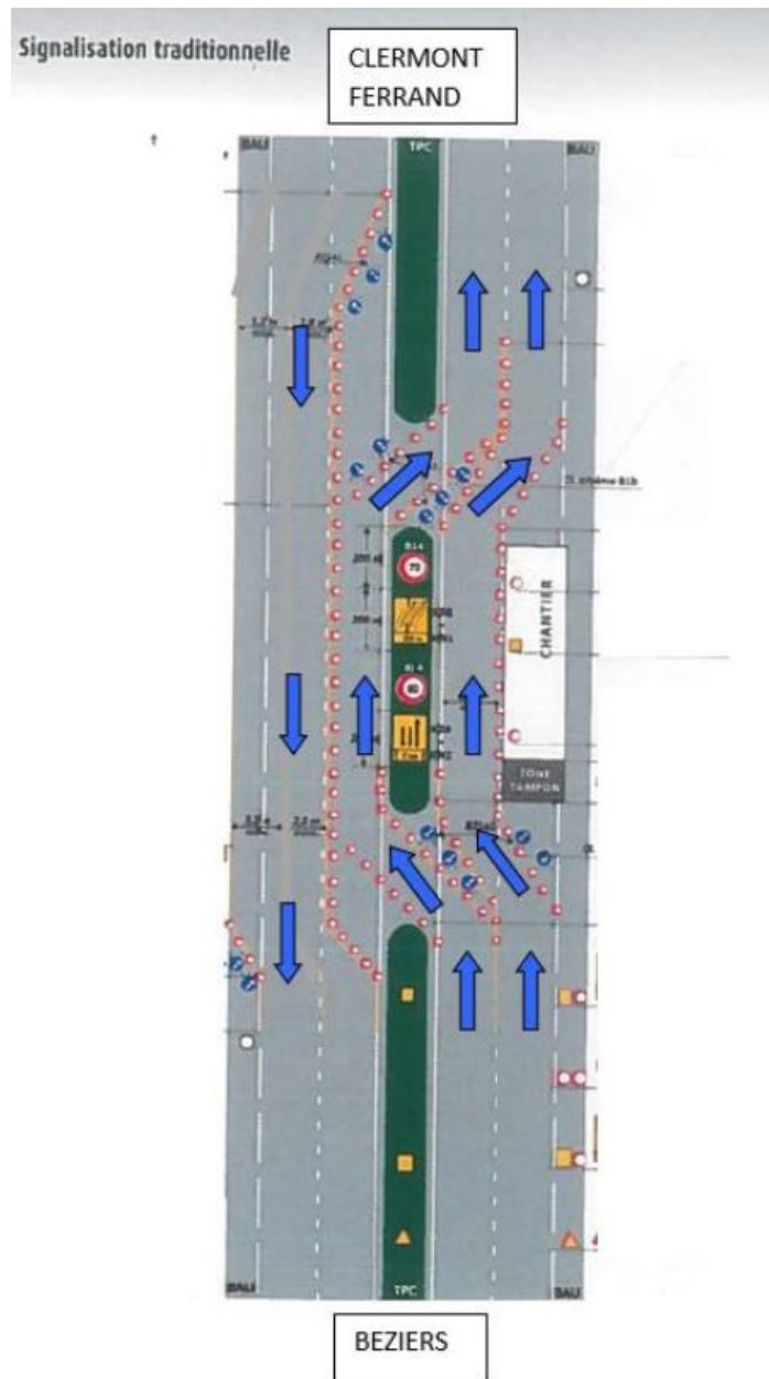
Schéma 3 : basculement partiel 2+1 et 1, optimisation du flux sens 2
