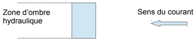
Zone située à l'arrière d'un bâtiment ou ouvrage existant par rapport au sens du courant. Le fait d'implanter un bâtiment dans l'ombre hydraulique d'un autre bâtiment limite son effet d'obstacle à l'écoulement.
