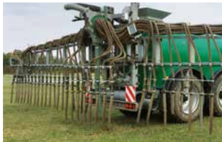
L'épandage du digestat par pendillards permet de limiter les émissions d'ammoniac par rapport à un épandage traditionnel en « buse palette ».
