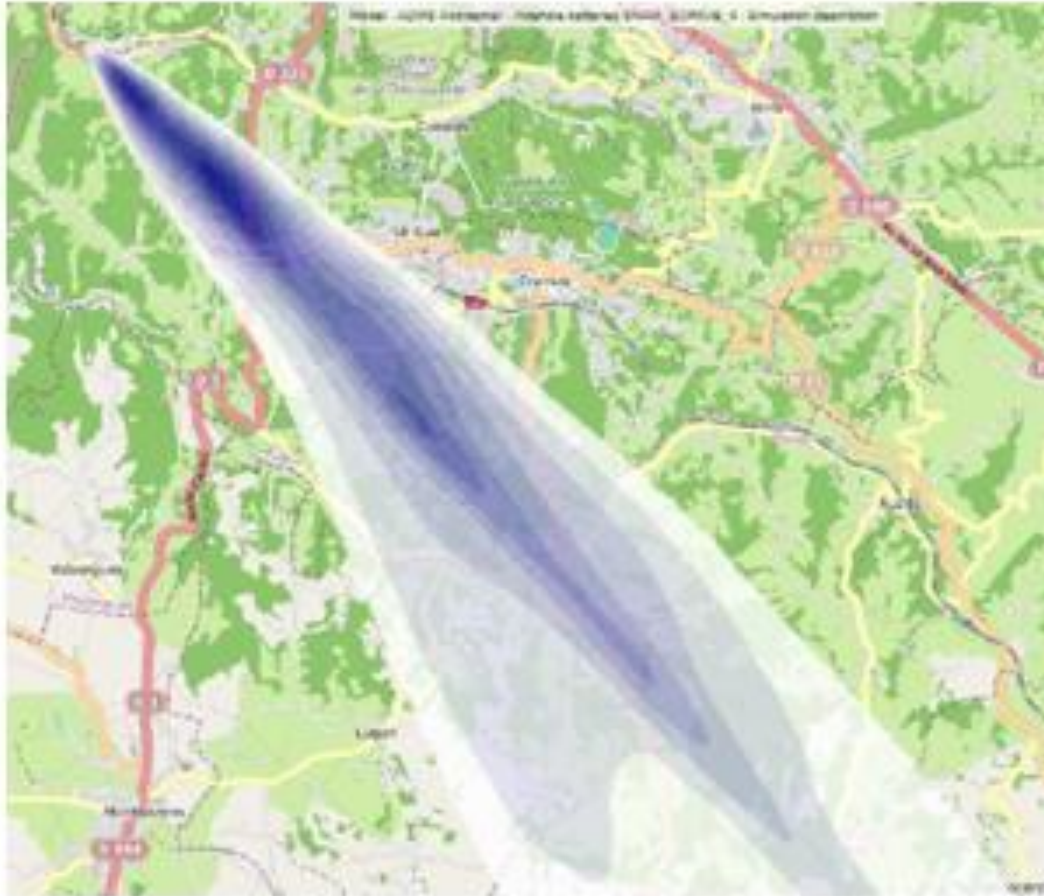
Figure 2 : Modélisation de la dispersion du panache de fumée (issue Cellule d'Appuis aux Situations d'Urgence - CASU)
